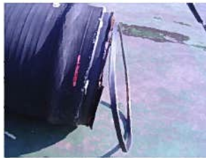
スリップアウトでの漏水 竣工前・他の機器の調整時 原因：バルブ操作ミスによる異常圧力
